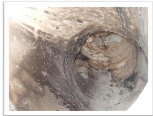
แสดงแป้งที่ลุกไหม้ในท่อใต้ไซโคลนร้อน
